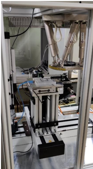
Abb. 2: Innenraum der Maschine mit Hexapod und Linearachsen
