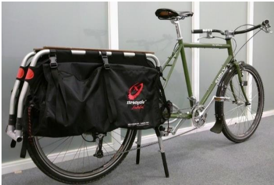
Abb. 3 Ein Longtail mit verlängertem Radstand nach hinten (Quelle: Yoichi Nakanishi via flickr, CC BY 2.0)
