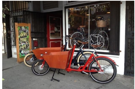
Abb. 4 Ein Short John und ein Long John mit verlängertem Radstand und Transportbox (Quelle: Umberto Brayj via Flickr, CC BY 2.0)
