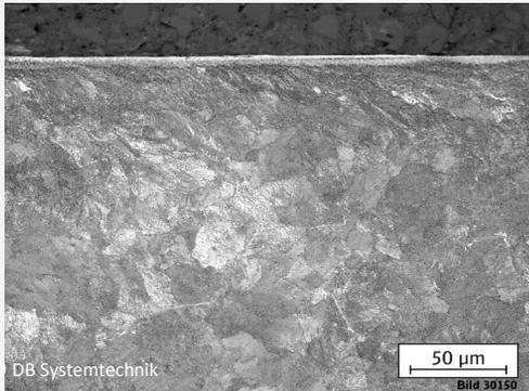
Schiene R260, Randgefüge befahren, mit „weißer Schicht“ durch Betrieb.
