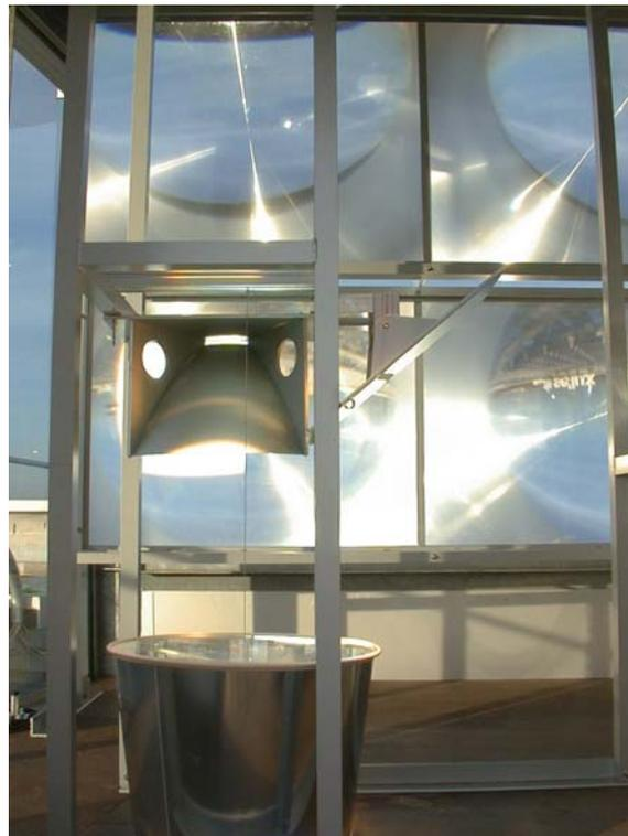
**Abb. 1:** Die optischen Systeme zur Einkopplung des Tageslichts ins Gebäude der ARTHELIO-Prototypen
