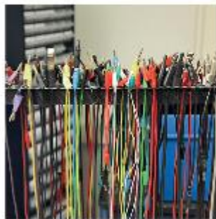
... und nutzen die Spezialkabelsammlung: BNC auf Banane, Krokodellerm auf Chinch
