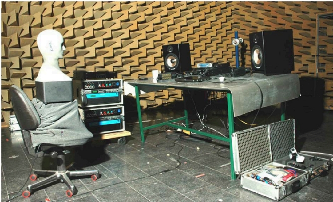
Abbildung 1.1 – Aufbau Kunstkopfmessungen von Monitorenpaaren bei Goertz/Makarski (Quelle: [Mak06])
